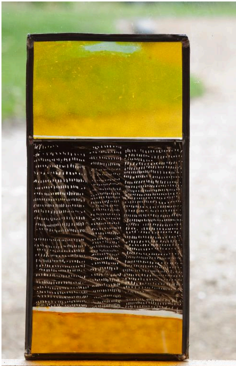
Panneau d'essai réalisé à la fin des années 1990 et conservé à l'atelier de Saint-Hilaire-en-Lignières. 20,5 x 40,5 cm, jaune d'argent, gravure, grisaille (petits traits grattés).
