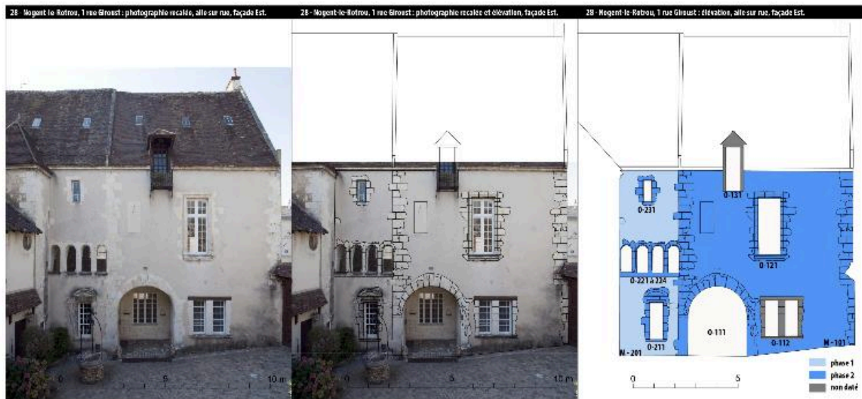
Photographie recalée et élévation, façade est, aile sur rue.
